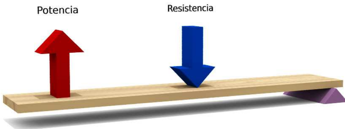
Figura 6.- Palanca de segunda clase. Representativa de la suspensión de un sujeto por dos puntos: potencia y apoyo (intercambiables). La resistencia es el peso, aplicado sobre el centro de gravedad. Imagen de www.wikipedia.org .
