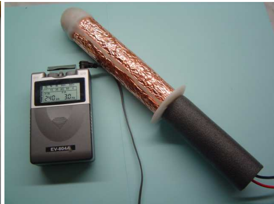
Electrodos bipolares caseros. Izda.: fabricado con un almirez y dos tiras de cobre. Posteriormente barnizado. Dcha.: Fabricado con “coquilla” de electricidad y forrado con lámina de cobre. Terminaciones con plástico termofusible.
