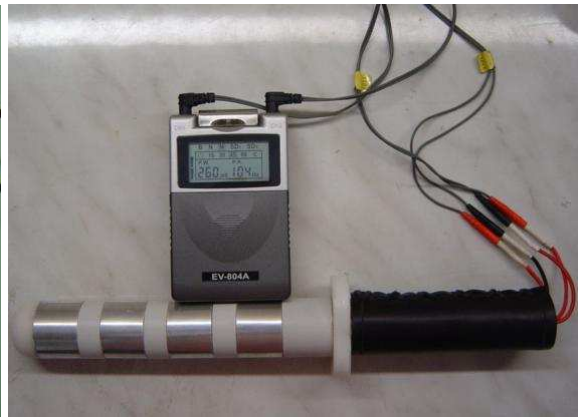
Electrodos caseros. Izda.: Dildo bipolar tipo samurai fabricado en plástico termofusible y láminas de aluminio rígido. Dcha.: Dildo cuadrupolar de dos canales. Sus posibilidades son casi ilimitadas como veremos después.
